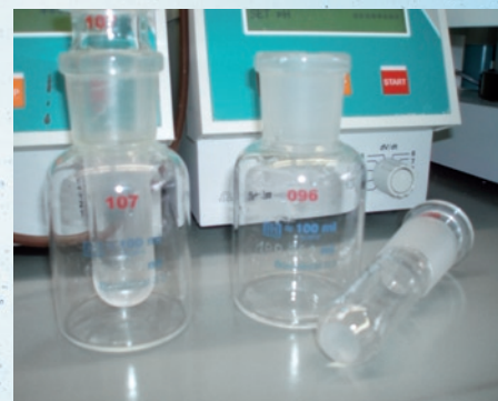
Abb. 1: Probenahme- und Titrationsgefäß nach DIN 38409 Teil 7 (DEV-H7, 1979-05)
