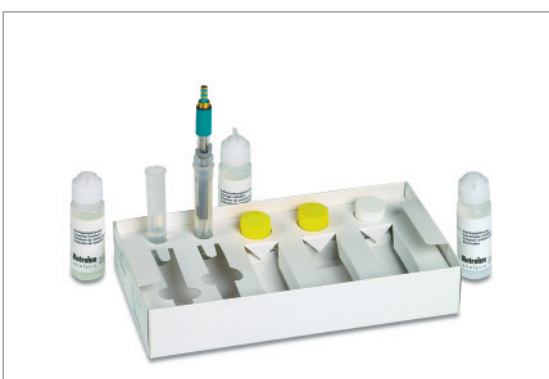
7. Sensor in Aufbewahrungslösung konditionieren
