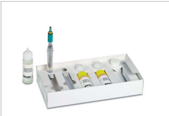
3. Elektrode bis über das Diaphragma in die Reinigungslösung eintauchen und einwirken lassen.
