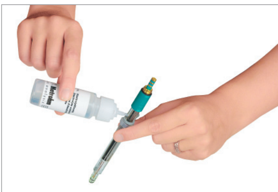
5. Elektrolytkammer mit Elektrolyt spülen und nachfüllen
