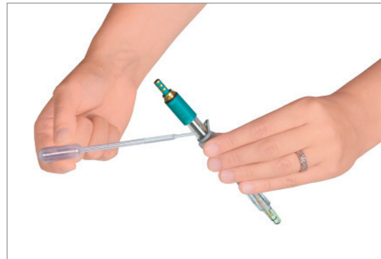
4. Anschliessend Elektrolytkammer entleeren
