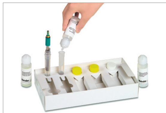
6. Aufbewahrungslösung im Elektrodenköcher erneuern
