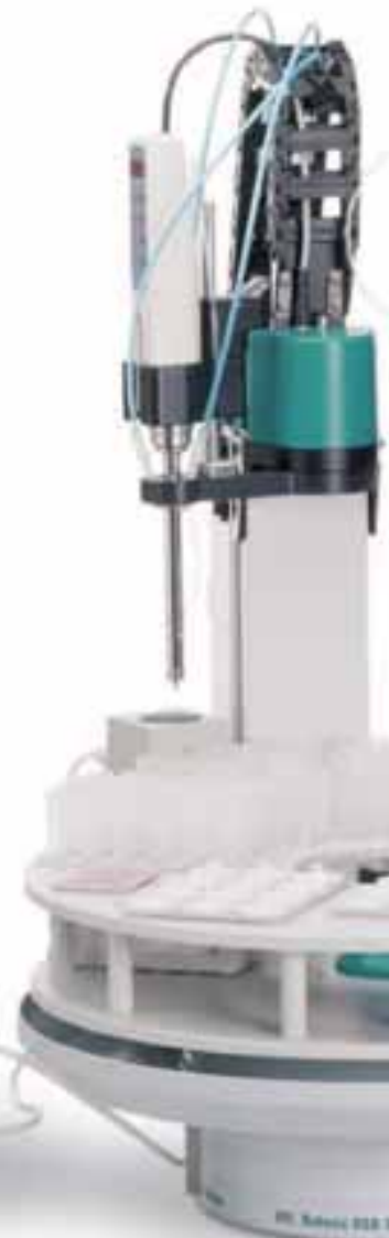
Voll automatische Probenvorbereitung und Analyse von Tabletten: Nach der Lösungsmittelzugabe zerkleinert der Hochfrequenz-Homogenisierer Polytron die Tabletten direkt im Probenbecher. Jede Probe wird gleich behandelt.
